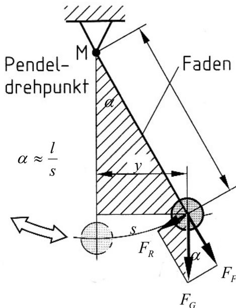
Das Bild zeigt die Zerlegung der **Gewichtskraft**  $F_G$  mit Hilfe eines Kräfteparallelogramms in eine **Kraft**  $F_F$  (die den Faden spannt) und die **Rückstellkraft**  $F_R$ . Die beiden schraffierten Dreiecke sind „ähnlich“ und führen somit zur Gleichung
