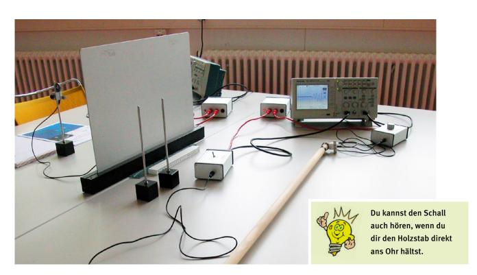
→ Führe dieses Experiment auch mit anderen Materialien durch (zum Beispiel mit einem Plexiglasstab, einem mit CO<sub>2</sub> gefüllten Ballon, usw.) Vergleiche anschliessend die Schallgeschwindigkeiten (Masseinheit: Meter pro Sekunde).
