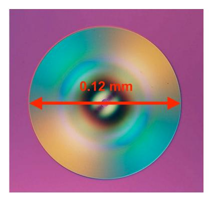
Fresnel-Zonenplatte für die Fokussierung von Röntgenstrahlen mit 0.12 mm Durchmesser. Der Fokus für einen Röntgenstrahl aus der SLS ist 30 cm von dieser Zonenplatte entfernt.
